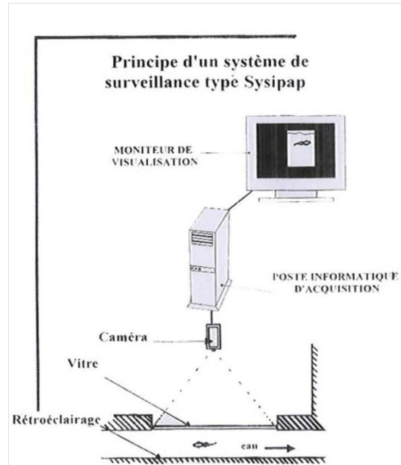
Figure 6 : Dispositif de surveillance vidéo d'Artix
