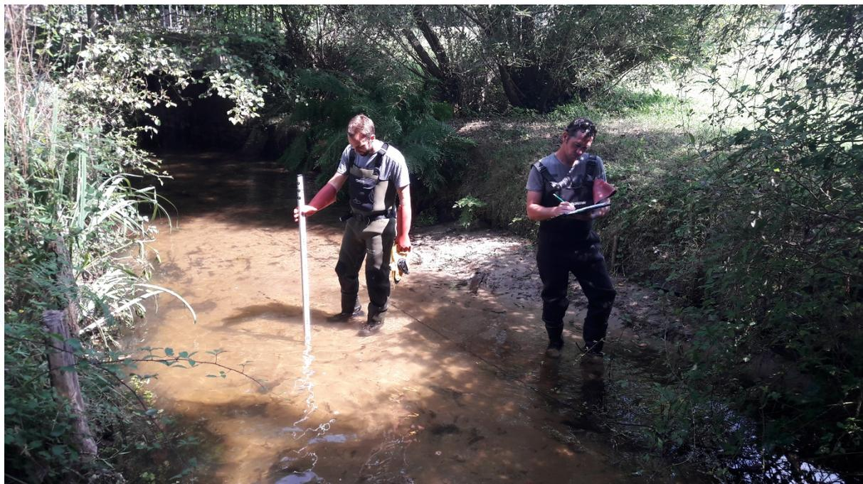
Figure 10 : Vue d'une mesure de profondeur sur le Ruisseau d'Hardy à Soustons
