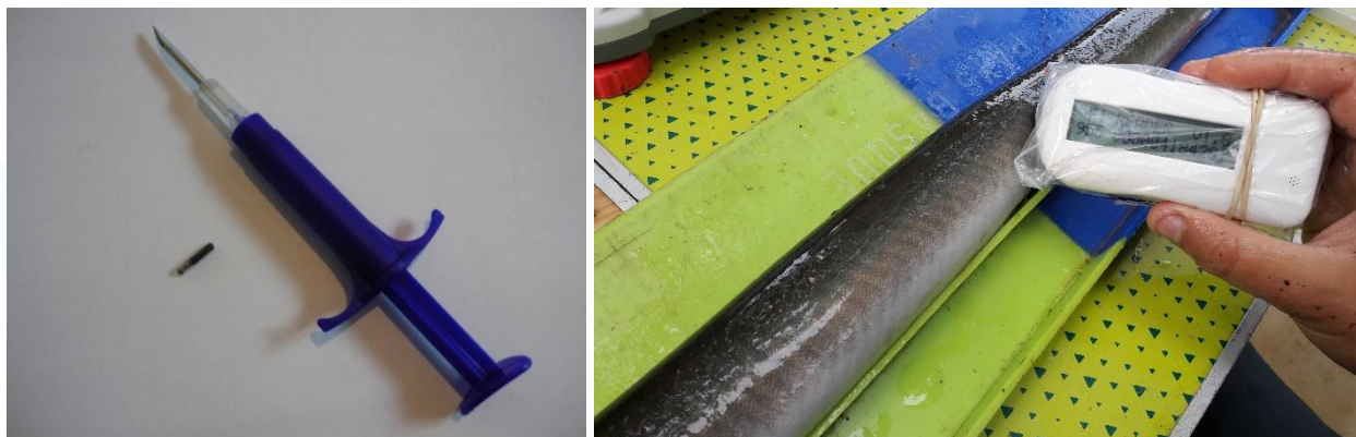
Figure 64 : Vues d'un trocart avec son transpondeur pit-tag 2x12mm et de la lecture du numéro d'identification
