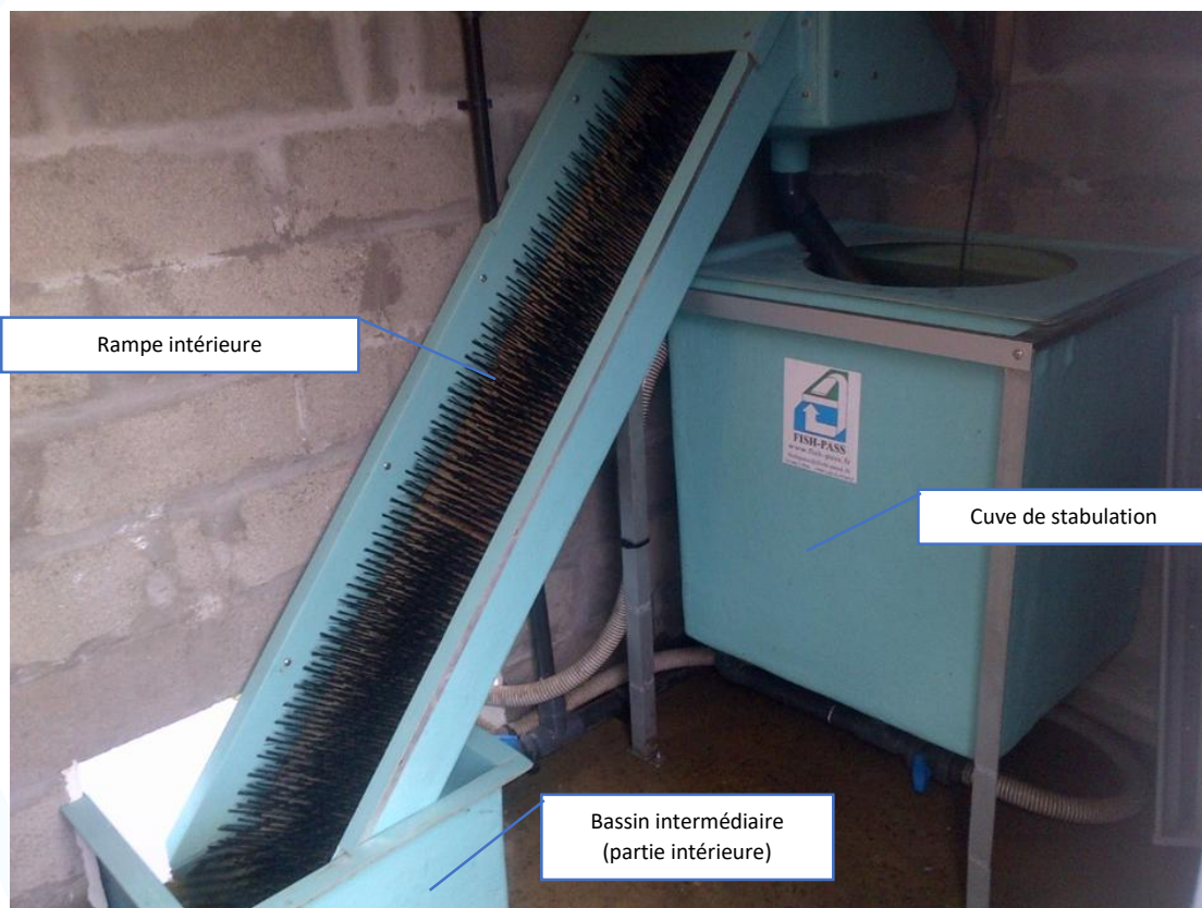
Figure 53 : Vue du dispositif de piégeage (partie intérieure)
