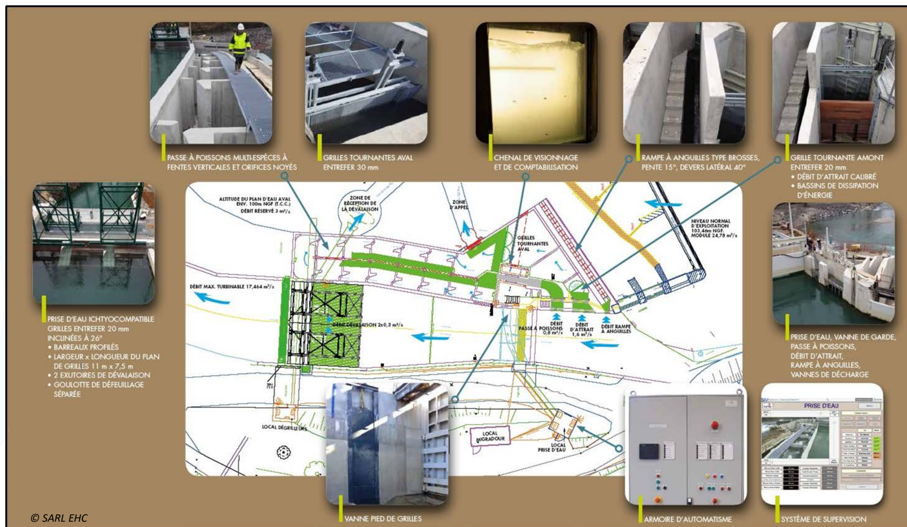
Figure 3 : Schéma descriptif du dispositif de franchissement de Charritte
