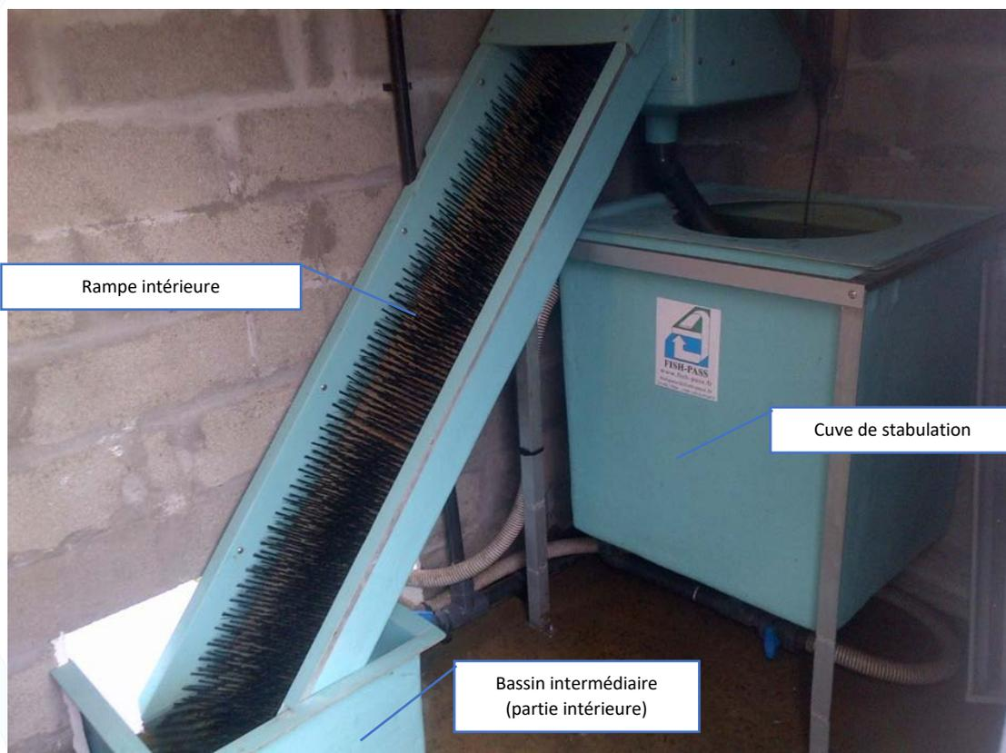
Figure 50 : Vue du dispositif de piégeage (partie intérieure)
